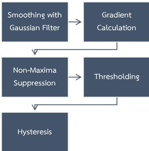
Figure 6. Canny Edge Algorithm
